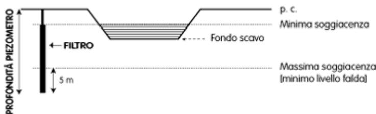
I piezometri devono essere perforati fino ad una profondità di almeno 5 m al di sotto del minimo livello (massima soggiacenza) raggiunto della falda.
