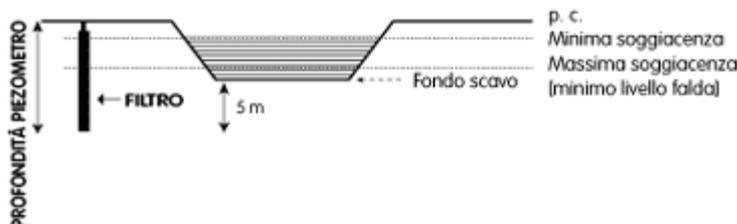
I piezometri risulteranno idonei qualora perforati fino ad una profondità di almeno 5 m al di sotto del fondo di escavazione esistente o di progetto (profondità autorizzata o raggiunta dall'escavazione anche in passato).
