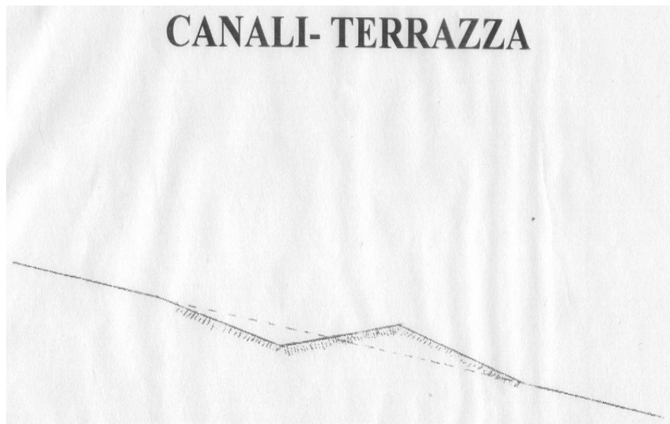
Fig. 6 Lo schema di un canale terrazza. La lunghezza dei tre fronti (scavo, pendenza e a valle, è in genere superiore a 4,2 m) .
