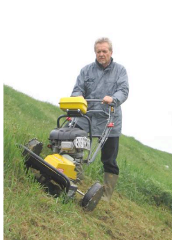
Rasa-trincia erba per il lavoro in spazi difficili e ristretti ed in condizioni di forte declività
