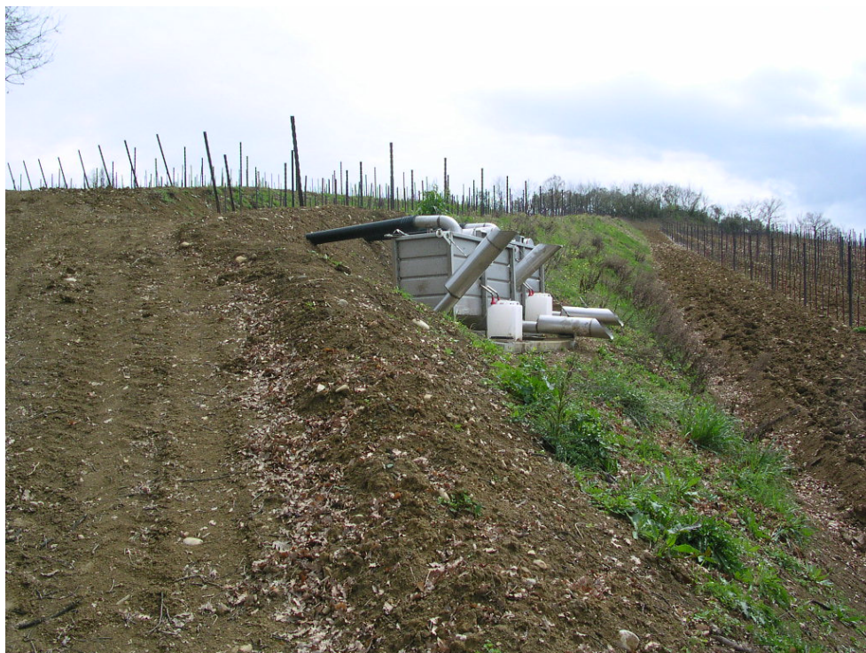
Fig. 16. la strumentazione per la misura dei deflussi e la raccolta delle torbide a Montepaldi.
