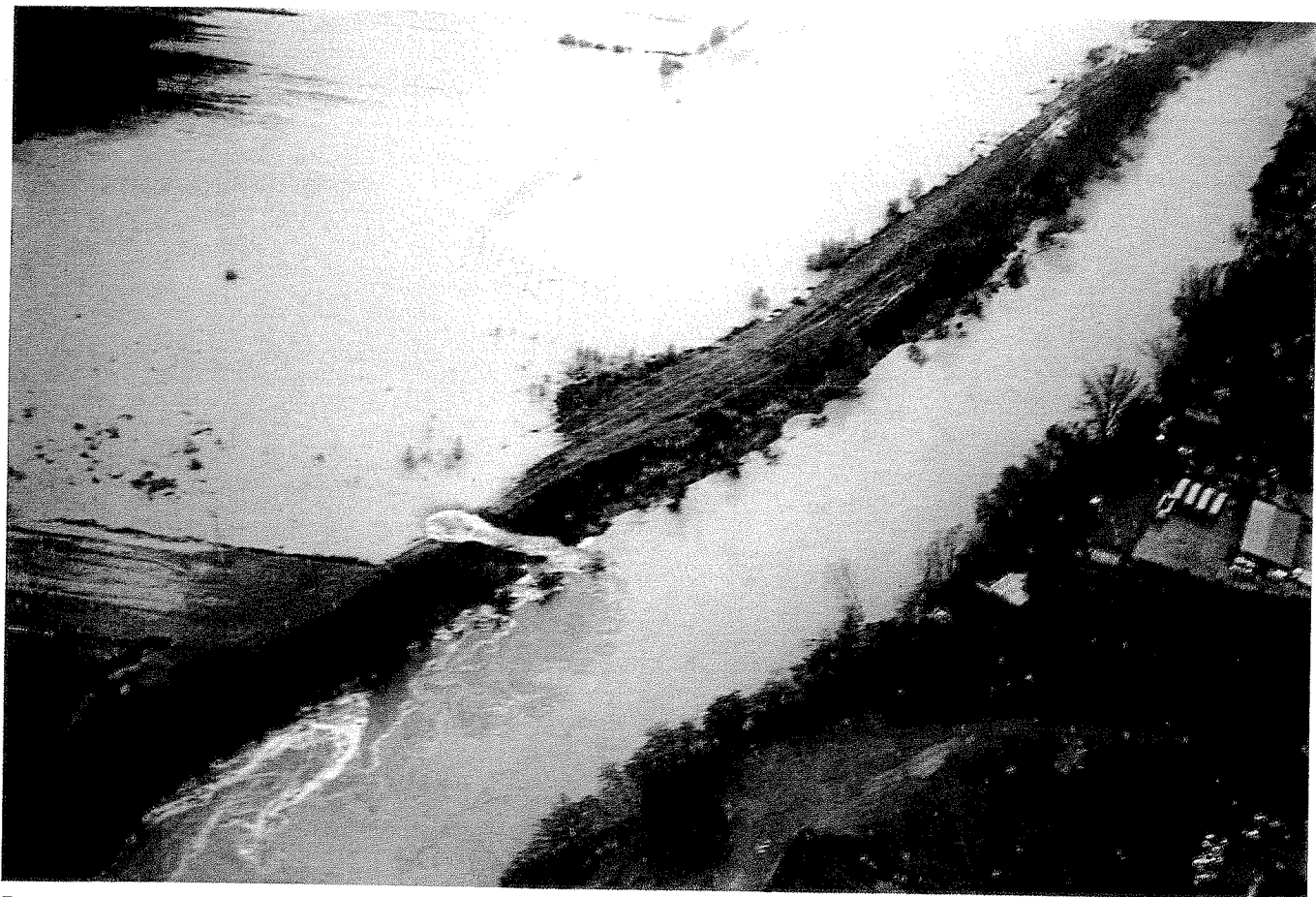
Rottura dell'argine e conseguente riflusso in Arno delle acque esondate in località "San Clemente", di fronte a Rignano (FI) [31 ottobre 1992 - Tav. 9 A].
