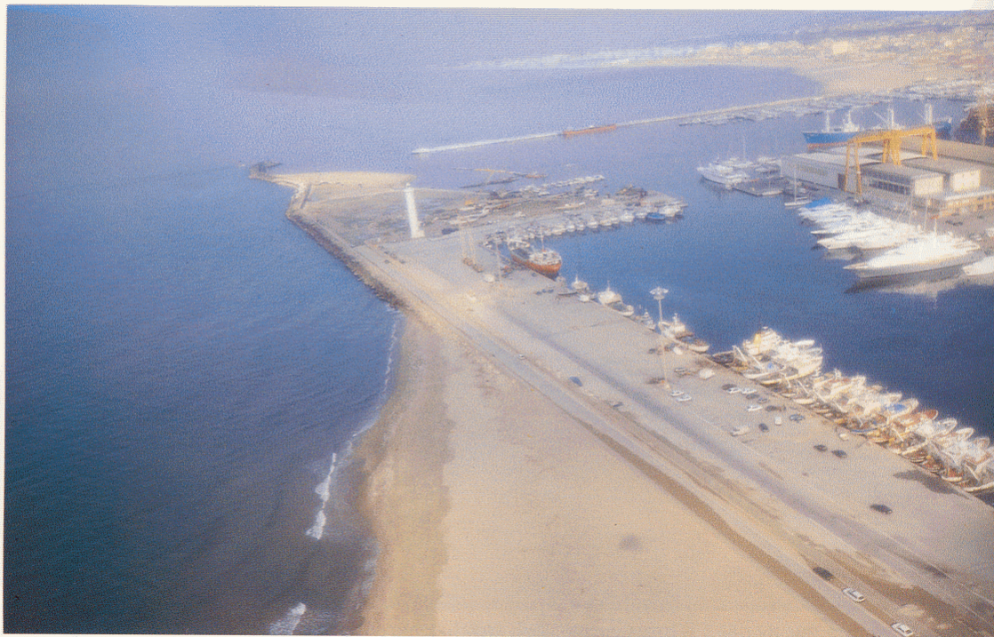
Porto di Viareggio: è visibile l'accumulo di sabbia a sud (in primo piano) e la luna di erosione a nord dell'imboccatura del porto.
