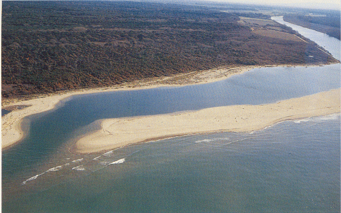
Foce del Fiume Serchio (PI) - L'andamento delle correnti da sud a nord ha causato la costituzione di una barra di sabbia con deviazione del tratto terminale del Fiume.
