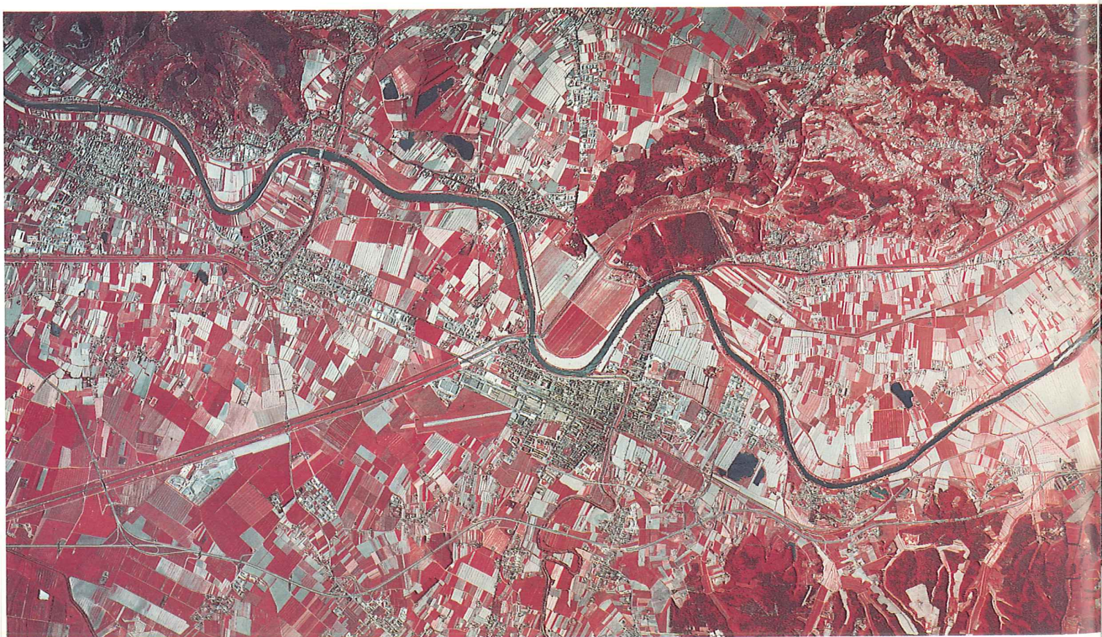
L'ARNO: tratto da Cascina a S. Miniato (Pi) - Sono visibili le golene lungo il fiume e le vaste aree di pertinenza fluviale, in parte edificate, nonché antichi meandri abbandonati (località Le Piagge - S. Donato). Da sinistra: il Canale Emissario del Padule di Bientina, che sottopassa l'Arno a S. Giovanni alla Vena; ad Ovest di Pontedera, lo Scolmatore, in grado di smaltire una portata di circa 1000 m 3 /s; l'immissione dell'Era nell'Arno e al centro, in destra d'Arno, il Canale Allacciante dell'Usciana, proveniente dal Padule di Fucecchio, che si immette nell'Arno nei pressi di Pontedera; la confluenza del T. Egola in sinistra d'Arno, di fronte a S. Croce. Sulla destra, l'ampio invaso artificiale in loc. Roffia, dovuto alle escavazioni di sabbia. Durante l'evento alluvionale dei giorni 20-21 ottobre 1992, la rot-
