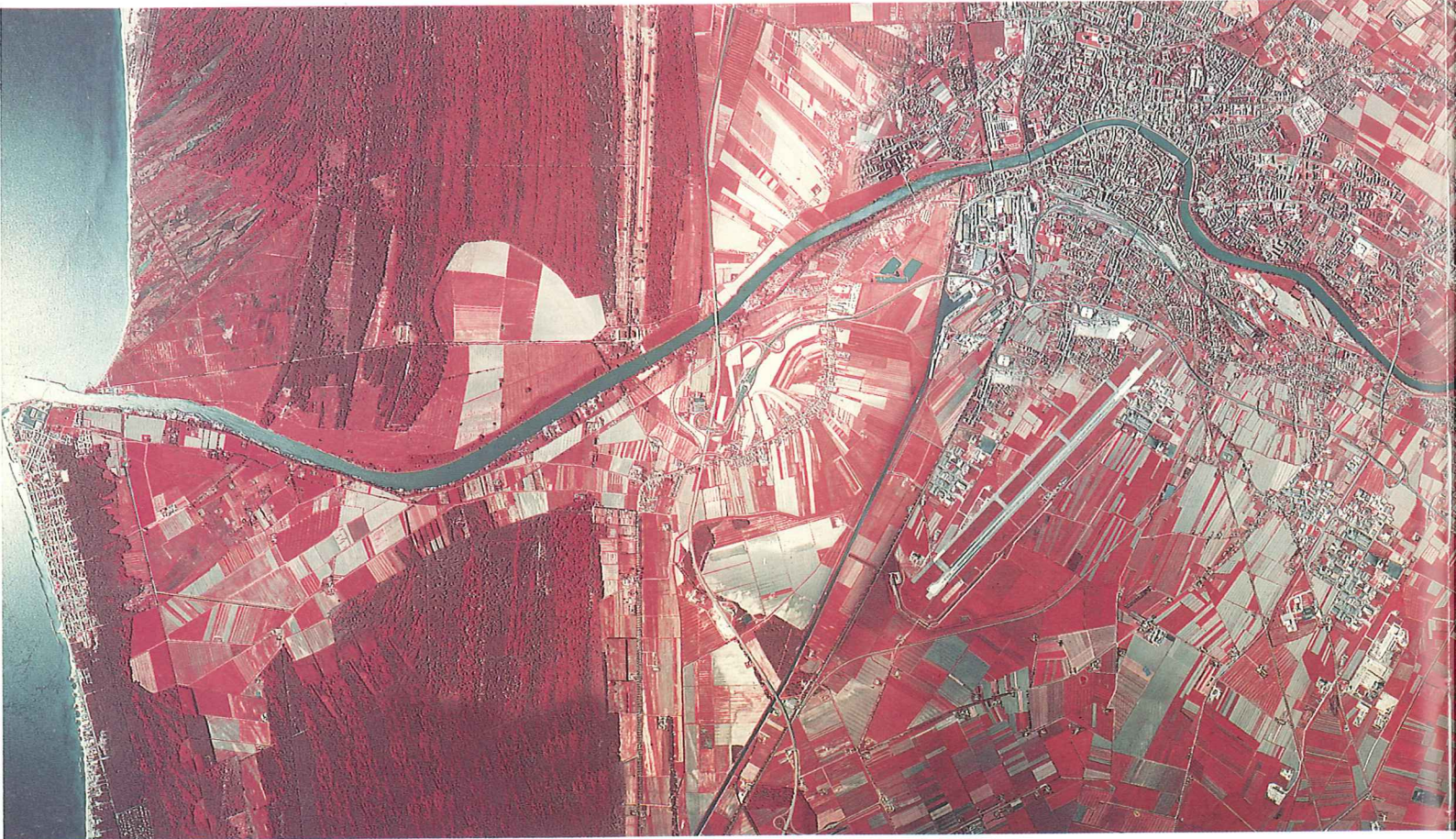
L'ARNO: tratto dalla foce a Cascina (Pi) - Sul litorale è visibile, a sinistra della foce, l'abitato di Marina di Pisa e, sul lato destro, l'erosione della costa nei pressi di S. Rossore. A valle della città di Pisa (al centro della foto), si nota la retifica dell'Arno dovuta al taglio dei meandri di Barbaricina (1770) e lo spostamento verso nord della foce ("taglio ferdinando", iniziato nel 1606). All'altezza di Pisa si evidenzia il restringimento dell'alveo nel centro della città. Tra Pisa, la zona di Cascina e fino alla valle di Bientina (sulla destra della foto), si notano i meandri del fiume, di varia ampiezza, in parte modificati. La costruzione degli argini e delle attigue strette golene, pre-
