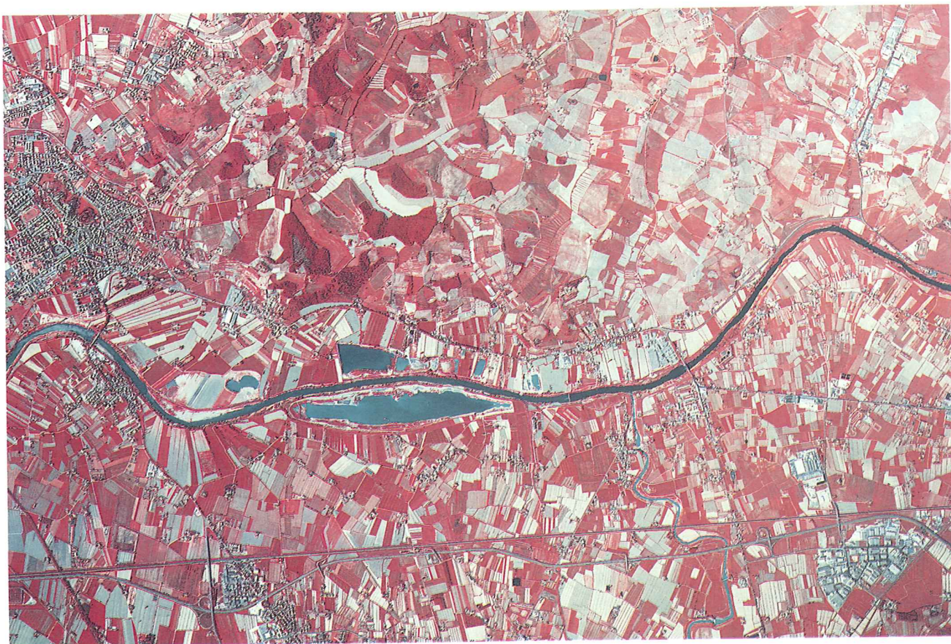
Antichi interventi di aggravamento del sistema idraulico dell'Arno - L'Arno tra Empoli e Fucecchio. Al centro della foto, in corrispondenza delle escavazioni in loc. "Roffia", si riconosce l'antico percorso a meandri e le ampie fasce di pertinenza fluviale, prima delle modifiche e delle arginature della metà dell'800.
