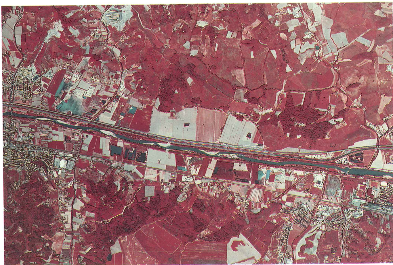
Antichi interventi di aggravamento del sistema idraulico dell'Arno - L'attuale corso dell'Arno tra Figline (FI) e S. Giovanni Valdarno (AR). L'andamento rettilineo del fiume e il suo restringimento sono il risultato della canalizzazione e del taglio di numerosi meandri, iniziata nei primi anni del 1700. La pianura alluvionale circostante è oggi intensamente urbanizzata.
