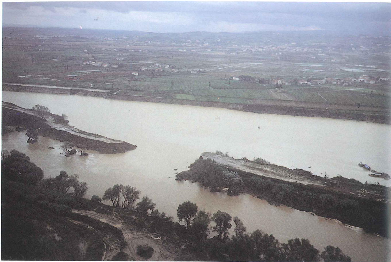
Eventi alluvionali recenti - Arno in località "Roffia", ad ovest di Empoli. La rottura del diaframma tra la sponda dell'Arno e la cava di sabbia durante l'evento alluvionale del 20 - 21 Ottobre 1992 laminò l'onda di piena abbassando il livello dell'acqua nel fiume, a valle, di oltre un metro e mezzo.
