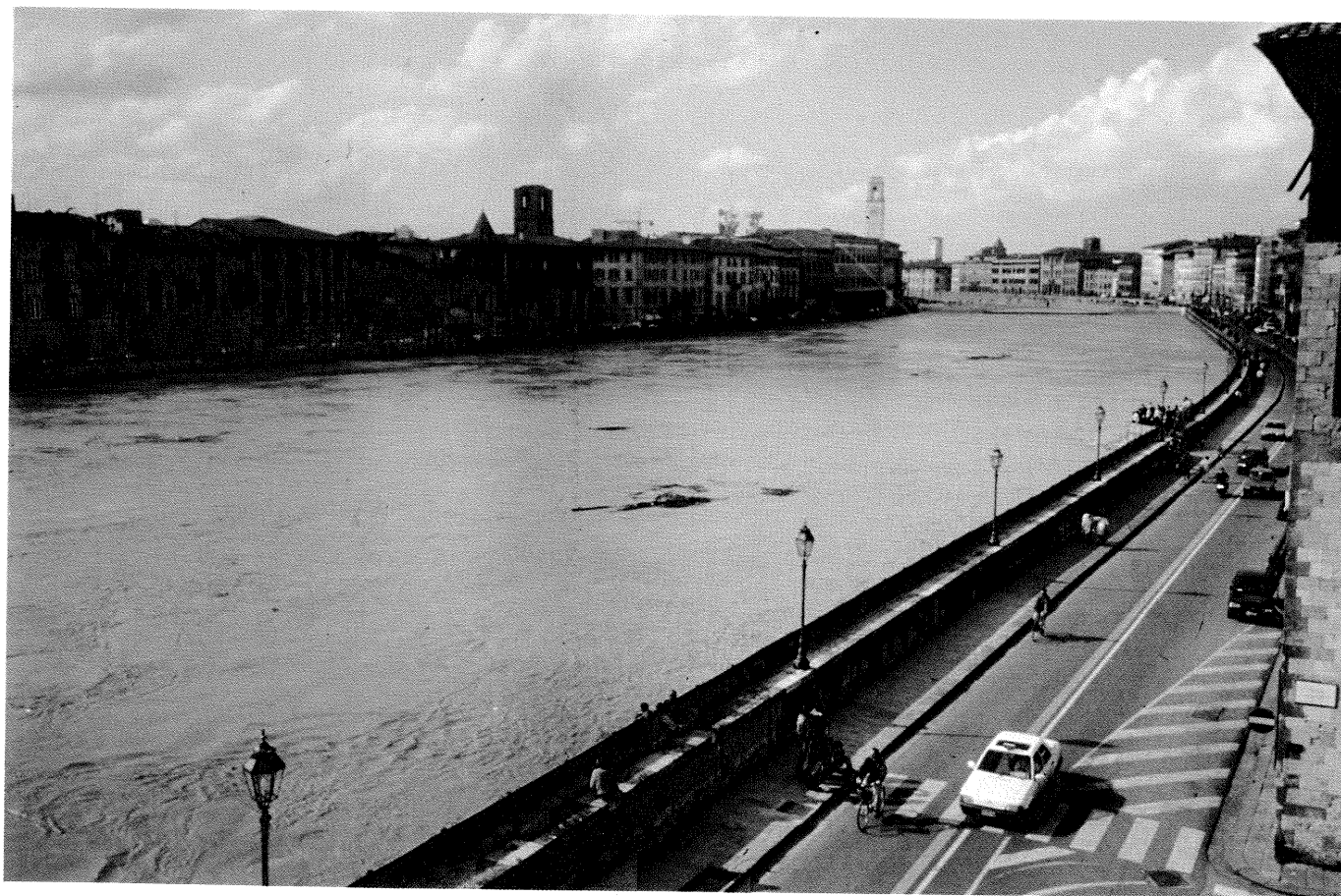
Portate di piena dell'Arno - Il fiume a Pisa durante la piena del 21 Ottobre 1992, quando raggiunse alla sezione degli Uffizi a Firenze la portata di 2200 \text{ m}^3/\text{s} . L'Arno passa in breve tempo da portate pressoché nulle (cfr. la fig. precedente) a piene come quella rappresentata. Durante l'alluvione del Novembre 1966, a Firenze la portata raggiunse i 4100 \text{ m}^3/\text{s} .
