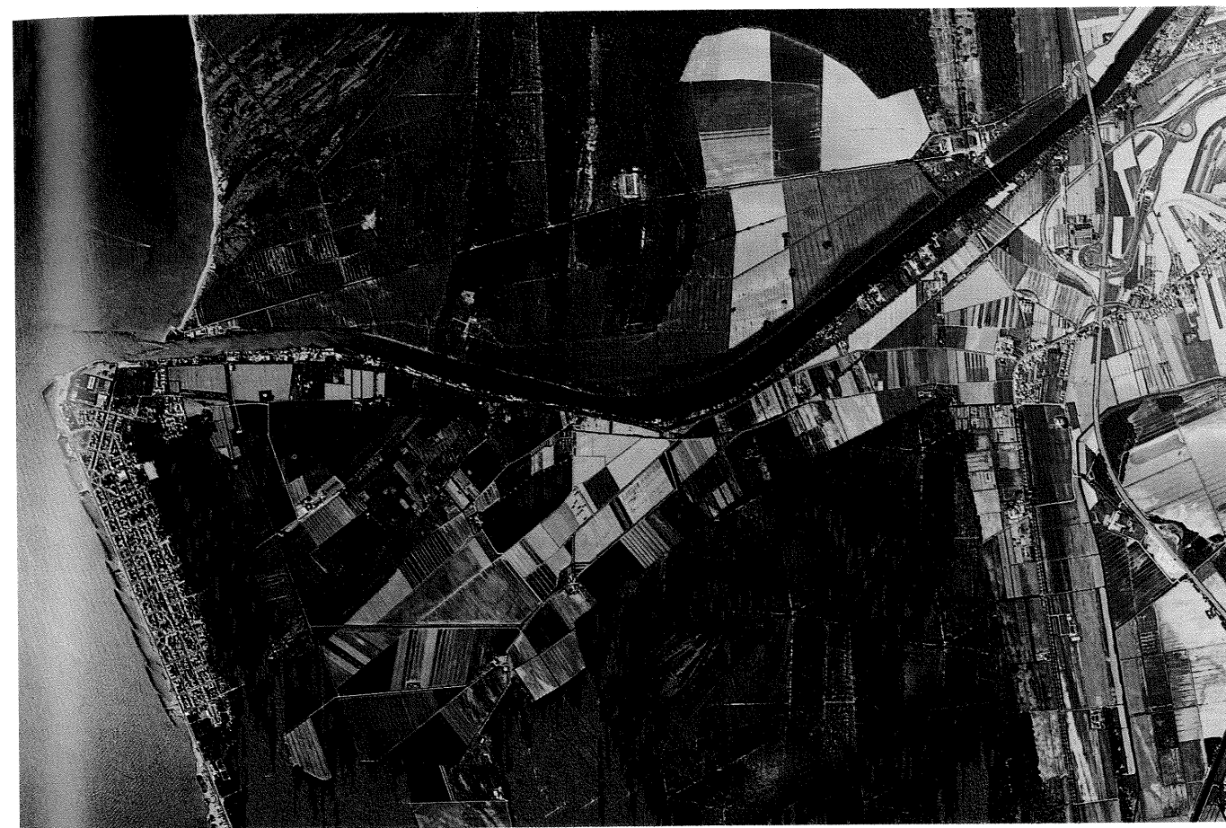
Antichi interventi di aggravamento del sistema idraulico dell'Arno - Canalizzazione e rettifica del fiume con taglio dei meandri di S. Piero a Grado e di Cascine Nuove di Barbaricina (1770-1774), a valle di Pisa. Nella foto è riconoscibile l'antico tracciato dei meandri ed è visibile la foce dell'Arno presso Marina di Pisa, difesa dalle scogliere a mare e l'erosione del litorale di S. Rossore, iniziata nel 1850. Lo spostamento verso Nord della foce dell'Arno, che fino al XV° secolo si trovava in corrispondenza della terminazione meridionale dell'attuale abitato, fu realizzata mediante il cosiddetto "taglio ferdinando", iniziato nel 1606.
