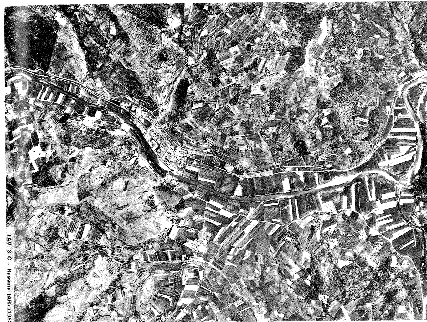
Trasformazioni del territorio (1954-1993): l'Arno presso Rassina (AR) - La scomparsa del reticolo idraulico minore e agrario e lo sviluppo edilizio nelle aree di pertinenza fluviale nel confronto tra foto aeree del 1954 (sopra) e del 1993 (sotto).
