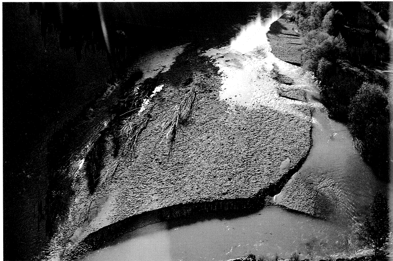
Manutenzione e sistemazione degli alvei - L'Arno tra Pratovecchio e Poppi (sopra) e a monte di Ponte Buriano (sotto) (nov.1992). Il progetto di piano prevede interventi di manutenzione e ripristino delle opere idrauliche esistenti, di consolidamento degli argini o delle sponde, di risagomatura delle sezioni ostruite dell'alveo e di rimozione delle piante spezzate, sradicate o adagiate nel fiume, (che rappresentano in certi casi un pericolo per la creazione di sbarramenti temporanei in corrispondenza di ponti, etc.), di potatura della vegetazione sulle sponde con tagli autorizzati e controllati dal Corpo Forestale, secondo precisi criteri (piano di manutenzione della vegetazione riparia e in alveo).
