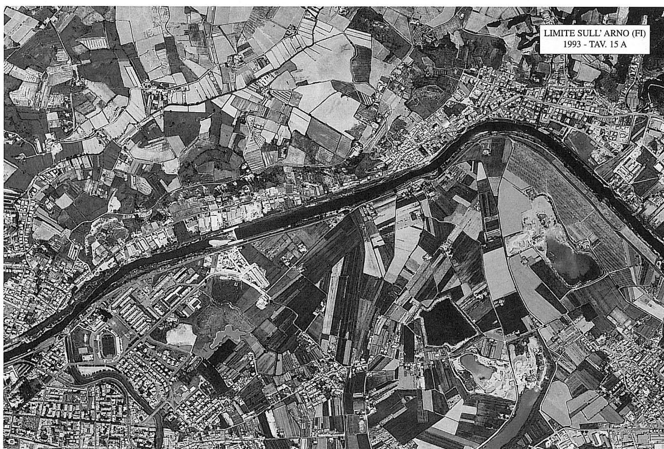
Trasformazioni del territorio (1954-1993): l'Arno presso Limite (FI) - La scomparsa del reticolo idraulico minore e agrario e lo sviluppo edilizio nelle aree di pertinenza fluviale nel confronto tra foto aeree del 1954 (sopra) e del 1993 (sotto). Si nota, al centro delle foto, l'antico meandro di "Arno Vecchio".
