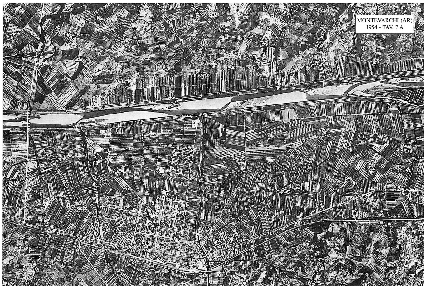
Trasformazioni del territorio (1954-1993): l'Arno presso Montevarchi (AR) - La riduzione del reticolo idraulico minore e agrario e lo sviluppo edilizio nelle aree di pertinenza fluviale nel Confronto tra foto aeree del 1954 (sopra) e del 1993 (sotto). Nelle foto, a destra, in alto, è visibile la confluenza dell'Arno con il T. Ambra.
