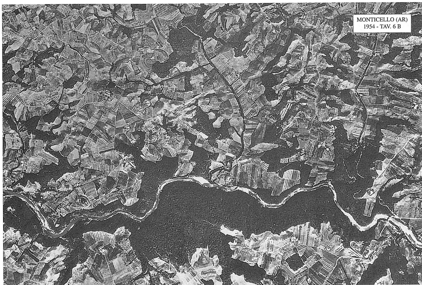
Trasformazioni del territorio (1954-1993): la valle dell'Arno in corrispondenza della diga ENEL di Levane (AR) - Confronto tra foto aeree del 1954 (sopra) e del 1993 (sotto). La costruzione della diga fu terminata nel 1958. Al centro, in alto, la confluenza con i torrenti Ascione e Agna.
