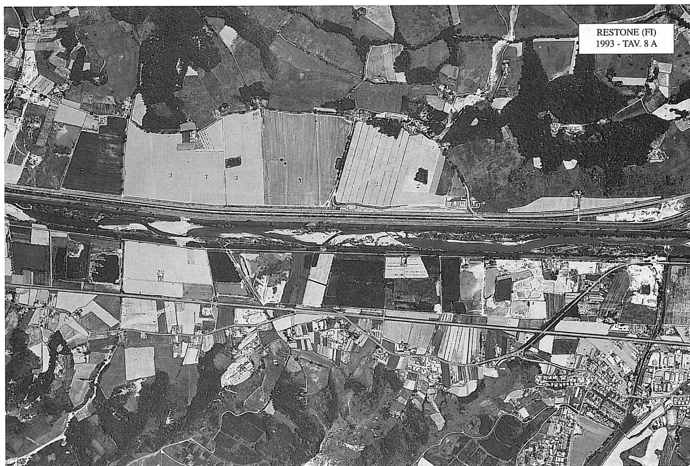
Trasformazioni del territorio (1954-1993): l'Arno presso l'abitato di Restone (FI) - Confronto tra foto aeree del 1954 (sopra) e del 1993 (sotto). Nell'area in sinistra e in destra del fiume, il piano di bacino individua casse di espansione per la riduzione del rischio idraulico.
