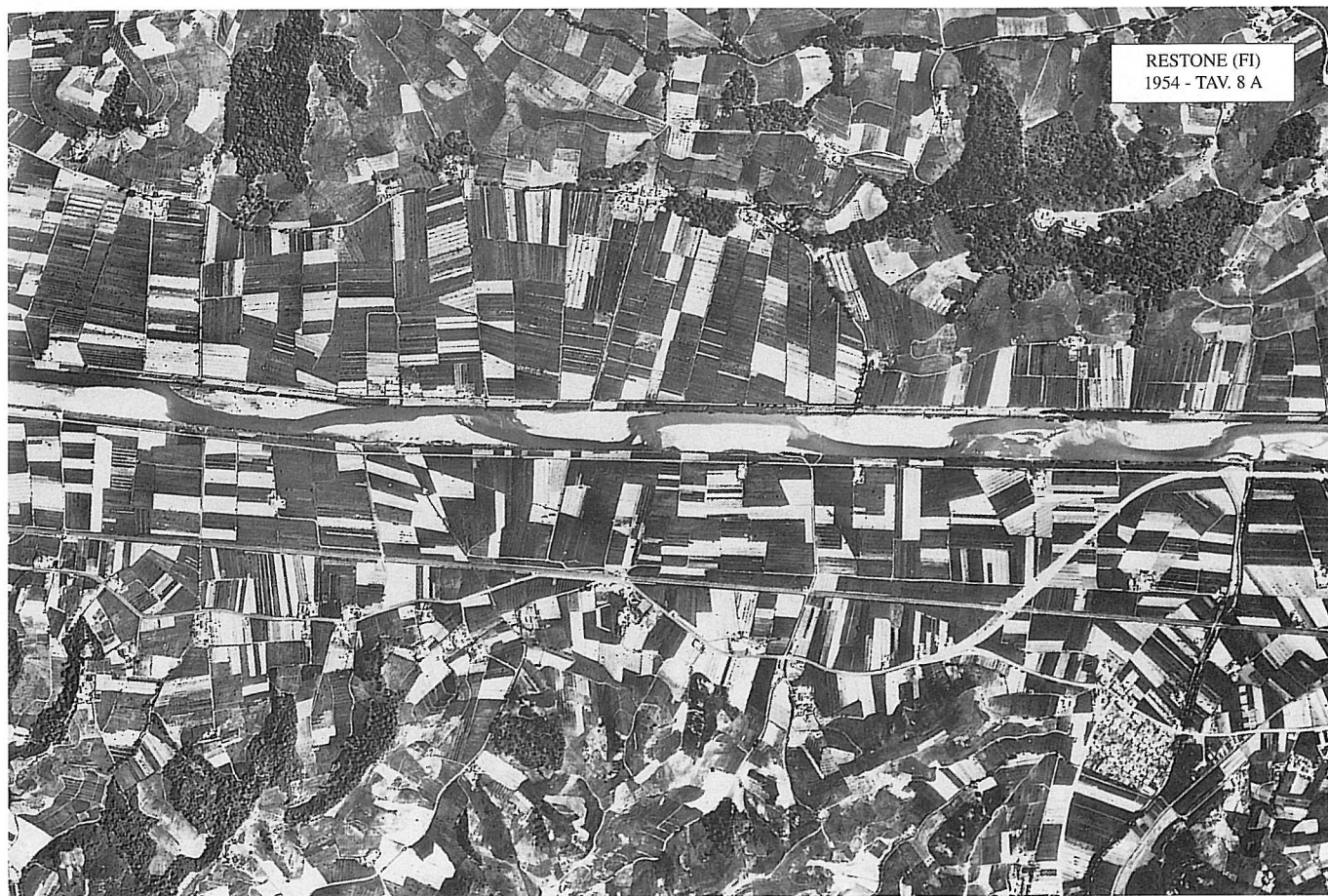
Trasformazioni del territorio (1954-1993): l'Arno presso l'abitato di Restone (FI) - Confronto tra foto aeree del 1954 (sopra) e del 1993 (sotto). Nell'area in sinistra e in destra del fiume, il piano di bacino individua casse di espansione per la riduzione del rischio idraulico.
