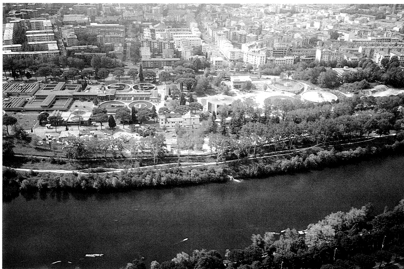
Firenze - Panoramiche sull'impianto dell'Anconella, che potabilizza l'acqua dell'Arno. Un secondo potabilizzatore (impianto di Mantignano) è costruito a valle della città (cfr. pag. 68).
