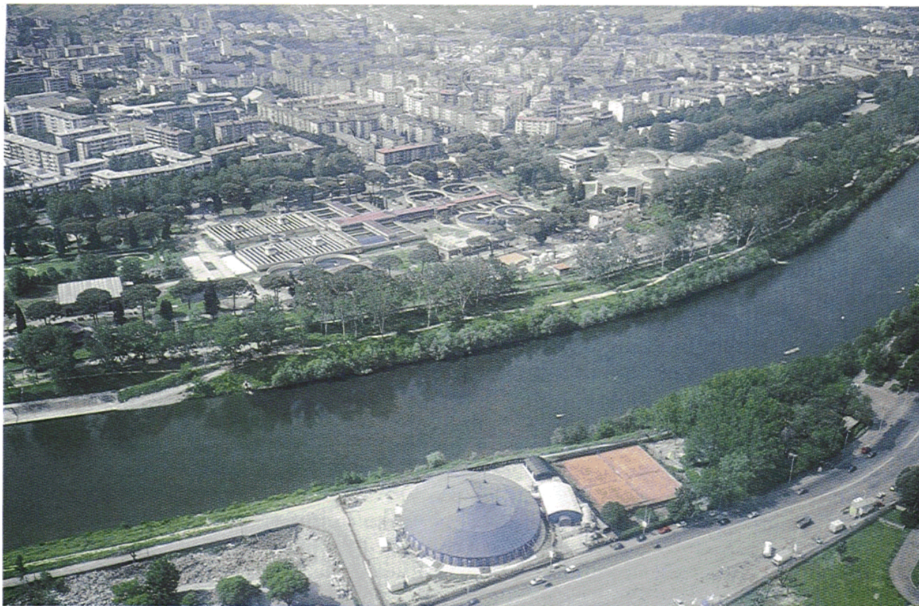
Firenze – Panoramica sull'impianto dell'Anconella, che potabilizza l'acqua dell'Arno. L'impianto ha una portata nominale di 4 \text{ m}^3/\text{sec} e una portata attuale di 2,4 \text{ m}^3/\text{sec} . Un secondo totalizzatore (impianto di Mantignano) è costruito a valle della città.
