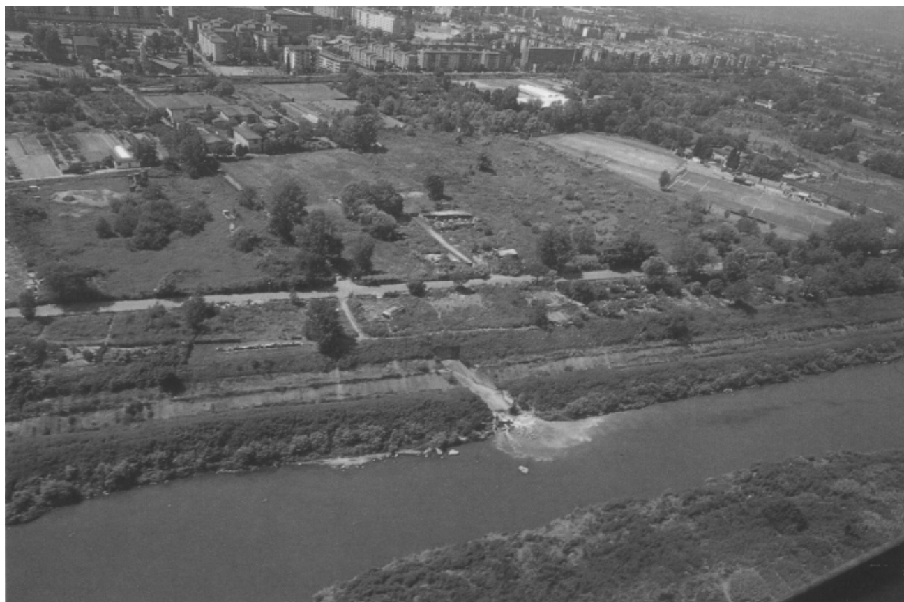
Firenze – Collettore "le Torri" (zona Argin Grosso) con scarichi fognari nell'Arno, provenienti dalla riva sinistra. La situazione attuale sarà superata con l'entrata in funzione del depuratore di Firenze e del comprensorio fiorentino (S. Colombano).
