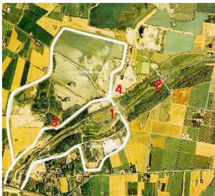
Figura 6 Esempio di cassa in derivazione: 1 traversa principale, 2 traversa secondaria, 3 sfioratore laterale 4 scaricatore (fiume Secchia)
