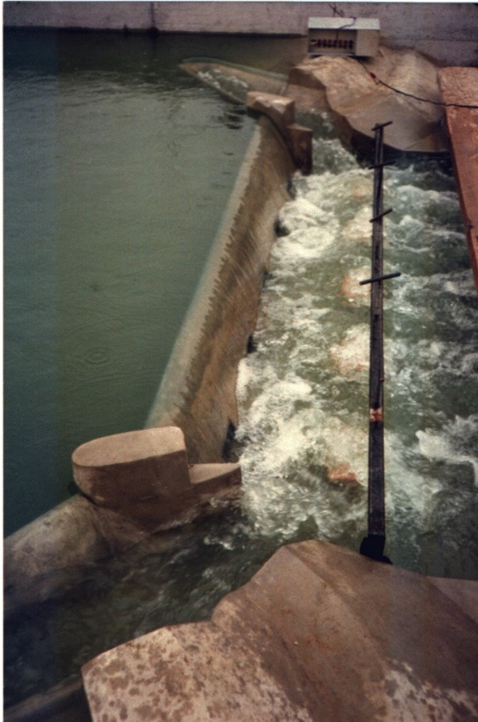
Figura 15 Modello fisico dello sfioratore laterale in funzione. Nella parte superiore della foto è visibile lo sfioratore di sicurezza.
